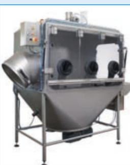
Pour le dessachage et le transfert en toute sécurité et en confinement total, nous complétons notre gamme d'extracteur de poudre par des boîtes à gants qui assurent la protection totale de l'opérateur et du produit lors de la manipulation de poudres toxiques, dangereuses ou stériles. Ces Extracteurs/Dévoûteurs peuvent être associés à tous les Systèmes de Transfert CERAM qu'ils soient sous vide, mécanique flexible ou vis d'Archimède.
