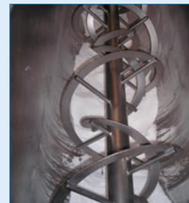
Les mélangeurs à double hélice permettent l'homogénéisation de pulvérulents intégré dans un process. D'un volume utile allant de quelques litres à plusieurs centaines de litres.
