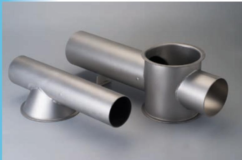
Sonde de raccordement entre le tube PA de l'alimentateur mécanique flexible et la prise matière. Dispose d'un bouchon de vidange en partie basse. Permet un raccordement à 45° ou 90° sur l'équipement. En inox 316L, finition microbillé. Existe en version raccordement clamp pour tube rigide inox.
