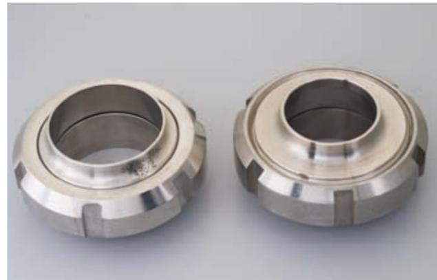
Férule SMS à souder. Inox 316L. En 3 parties: nez à souder, douille lisse et joint.
