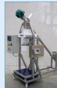
Ceram a développé une large gamme de doseurs, tant volumétrique que pondéraux, batch ou continus par perte de poids. Remplissage de sacs à usage commercial avec poinçon et vérification annuelle par un organisme agréé. Remplissage d'une trémie à usage interne dans le cadre d'un process intégrant de la formulation. Dosage multi produits en amont d'un mélangeur avec traçabilité des batches et gestion du stock de matières premières.
