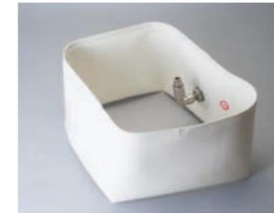
Joint torique gonflable pour remplissage de sac. Polyuréthane agréé contact alimentaire. Equipé d'une valve pour le gonflage. Pmax: 2 bars.
