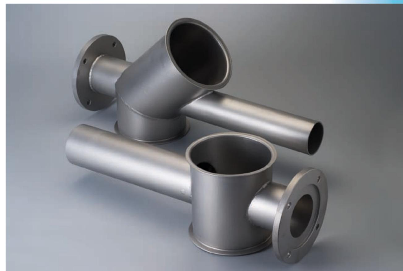
Goulotte de raccordement entre le tube PA de l'alimentateur mécanique flexible et le moteur. Permet un raccordement à 90° sur l'équipement. En inox 316L, finition microbillé. Existe en version raccordement clamp pour tube rigide inox.
