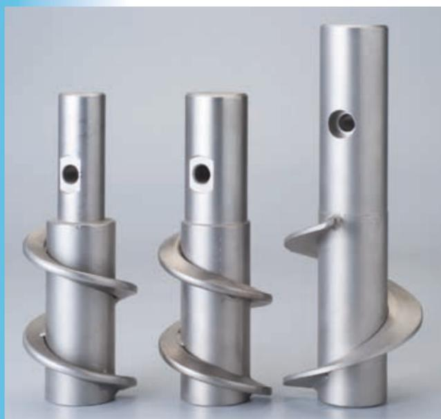
Bague d'entraînement entre le moteur et la spire de l'alimentateur mécanique flexible. En inox 316L. Existe en version à baïonnette pour un démontage rapide.
