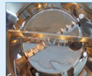
L'extracteur dévoûteur permet l'extraction sous un silo ou une trémie, de pulvérulents de mauvais écoulement. Un système performant de dévoûtage assure un écoulement régulier du produit. Un système d'émottage peut être intégré au dévoûteur, en variante. La reprise sous l'extracteur peut-être assurée par un SUPERVAC, une vis ou un alimentateur flexible à spire. L'extracteur dévoûteur nécessite un minimum d'entretien. Son démontage est facile et rapide.
