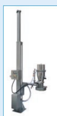
Équipement servant au positionnement de tout type de transfert pneumatique de la gamme SUPERVAC. Permet le remplissage de conteneur ou l'alimentation de matériels (Mélangeur, tamiseur, broyeur...). La position basse de la potence permet la maintenance et le nettoyage aisé du matériel de transfert pneumatique. La rotation du bras de la potence assure le dégagement automatique du SUPERVAC de la zone de remplissage jusqu'à la position de maintenance.
